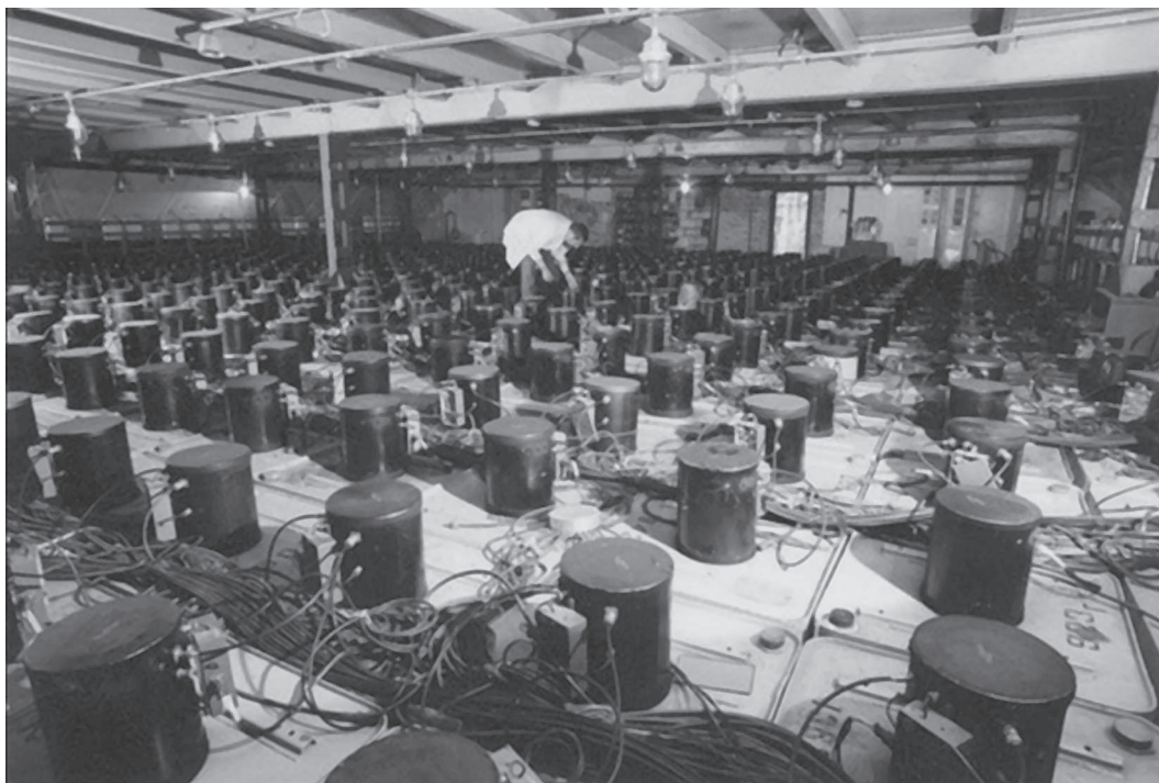
Сцинтилляционные детекторы на верхней горизонтальной плоскости Баксанского подземного сцинтилляционного телескопа.
